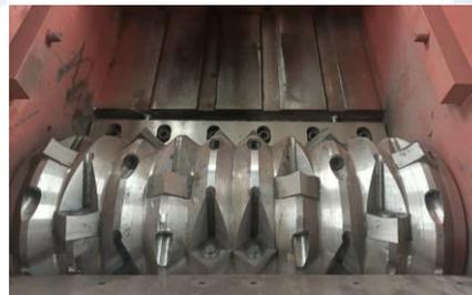
Rotor maquinado en una sola pieza con rodamientos dentro de la estructura principal.
