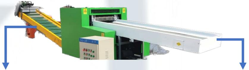
Transportador inclinado para salida de material del molino en acero inoxidable con guardas laterales incluido.
